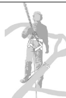
Esempi di uso di funi e ganci per assicurare una posizione sicura tratti dal draft amendment ISO 11681-2: 1998/DAM1)
